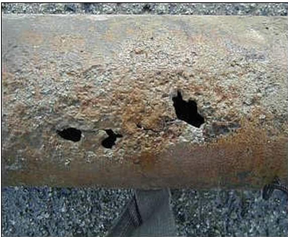
Figura 1: Duto de aço com corrosão.
