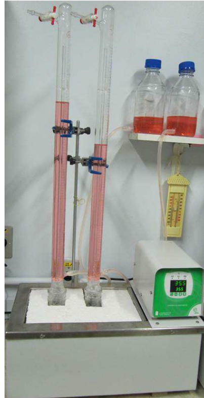
Figura 4.6 – Equipamento para ensaio BMP com 2 tubos eudiométricos.
