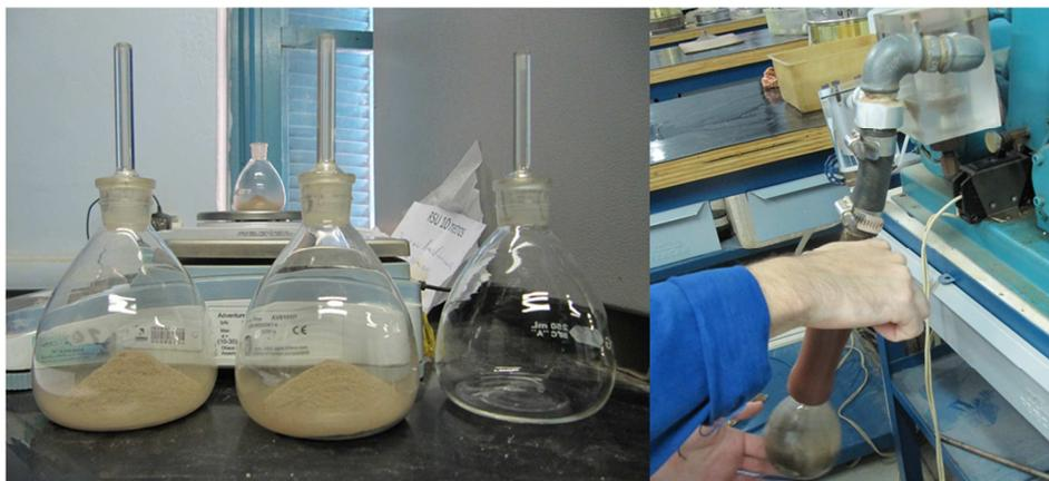
Figura 3.19 – Pesagem do material nos picnômetros e aplicação do vácuo
