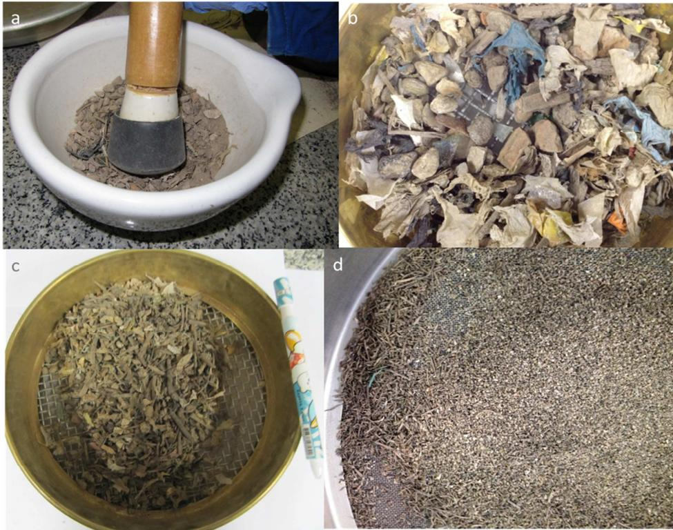
Figura 3.17 – Destorroamento e peneiramento da fração grossa. (a) é o processo de destorroamento; (b) é o material retido na peneira #5/16; (c) é o material retido na peneira #4; (d) é o material retido na peneira #40.
