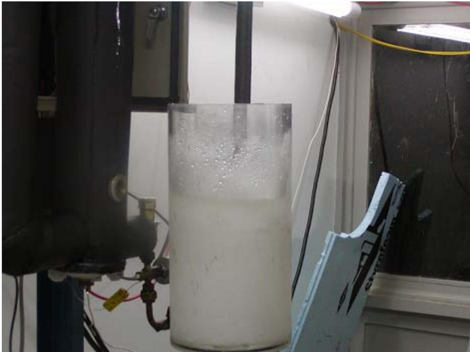
Figura 49 - Amostra de pasta de gelo produzida pelo gerador
