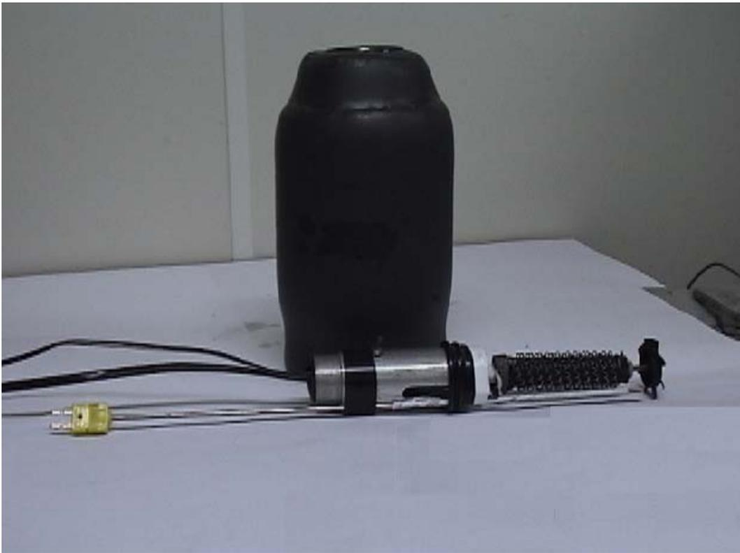
Figura 42 - Vista do calorímetro empregado na determinação da fração de gelo
