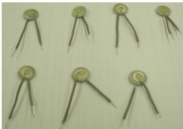
Figura 26 Pastilhas preparadas para a caracterização elétrica.
