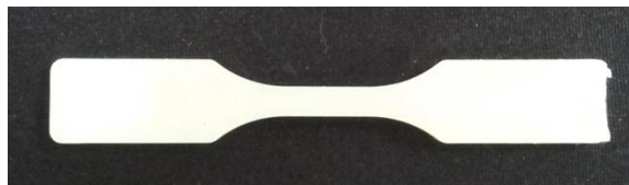
Figura 24: Formato do corpo de prova fabricado na microextrusora e na microinjetora.
