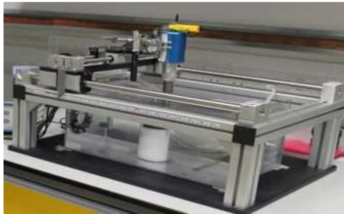
Figura 28. Sistema de posicionamento do transdutor
