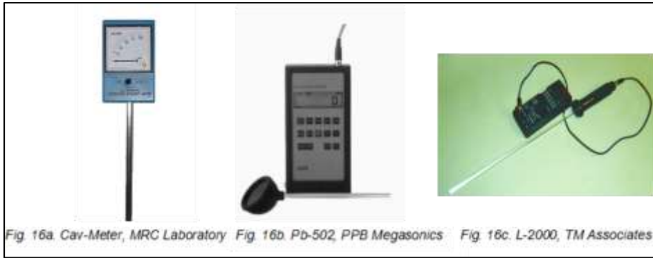
Figura 16. Medidores de cavitação
