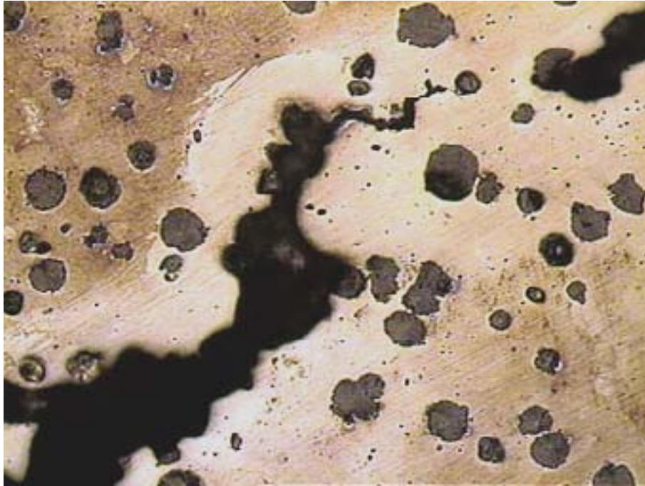
Figura 2.3 – Propagação de trincas entre os nódulos de grafita em ferro fundido.
