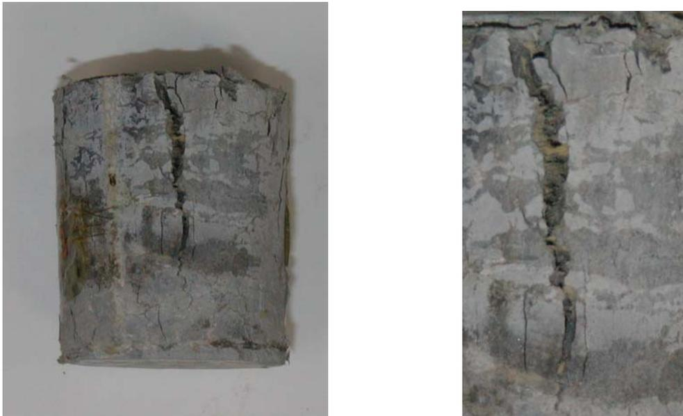
Figura 4-5 Espécime ensaiado e detalhe da ligação matriz–fibra.
