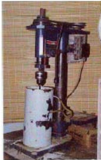
Figura 3-1 Equipamento utilizado para a dispersão da polpa.
