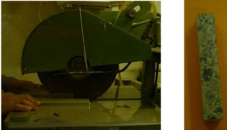
Figura 3-7 Serra circular para corte e detalhe do corpo de prova.
