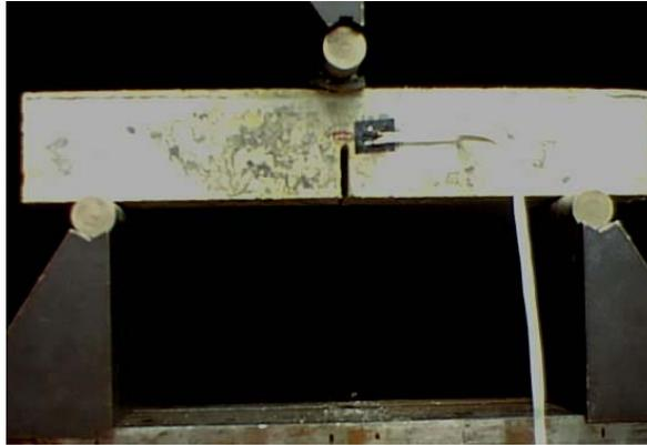
Figura 3-9 Ensaio de flexão para corpos de prova com entalhe.
