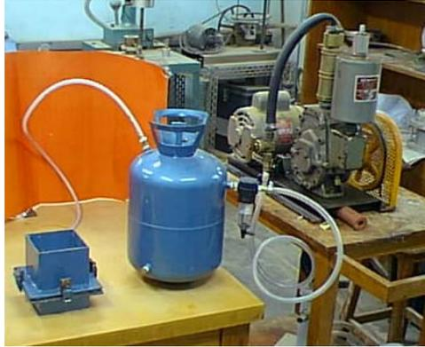
Figura 3-2 Câmara de moldagem e recipiente e bomba.
