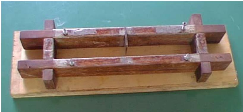
Figura 3-5 Molde prismático com entalhe.
