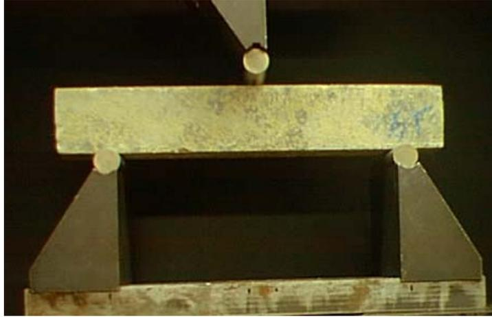
Figura 3-8 Ensaio de flexão para corpos de prova sem entalhe.
