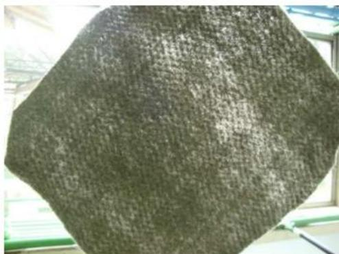
**Figura 2.2 Amostra de geotêxtil exposta contra a luz.**
