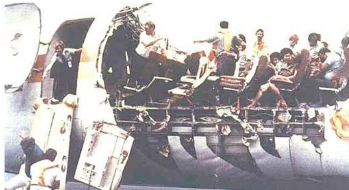
Figura 25 - Falha estrutural ocorrida em uma aeronave, devido a falhas na detecção de processos de corrosão por tensão na sua fuselagem de alumínio. (Fonte: http://aviationtroubleshooting.blogspot.com.br/2010_10_01_archive.html )
