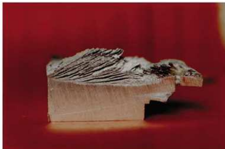
Figura 24 - Corrosão por esfoliação em uma peça feita de liga de alumínio. (Fonte: http://www.epoxipiso.com.br/2012/11/formas-de-corrosao.html , acessado em 15/09/2013)
