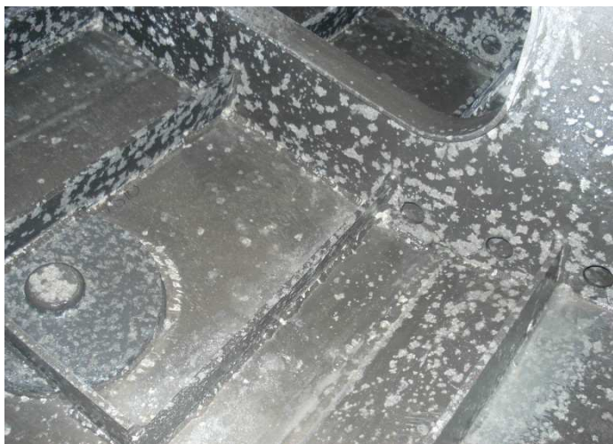
Figura 22 - Corrosão por pontos em uma peça de alumínio (Fonte: http://www.amteccorrosion.co.uk/aluminium.html , acessado em 15/09/2013).
