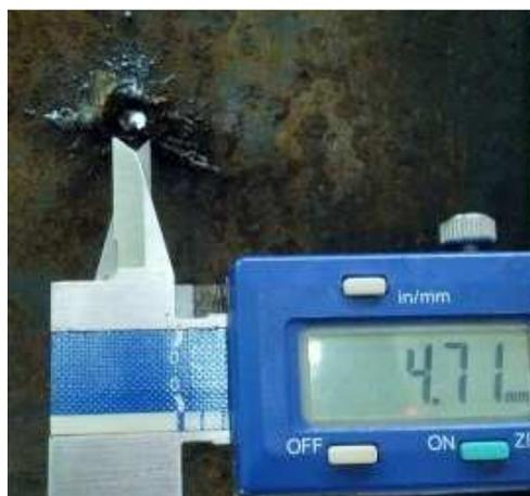
Figura 62 – Medida do diâmetro do furo central com paquímetro digital na placa de aço da 3ª amostra de aço/cimento/carbonato travertino (CIM 042/13 - pasta pré-sal)
