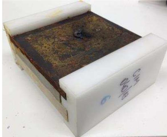
Figura 63 – Vista do furo central na placa de aço da 6ª amostra de aço/cimento/carbonato travertino (CIM 040/13 - pasta de cimento pura curada)
