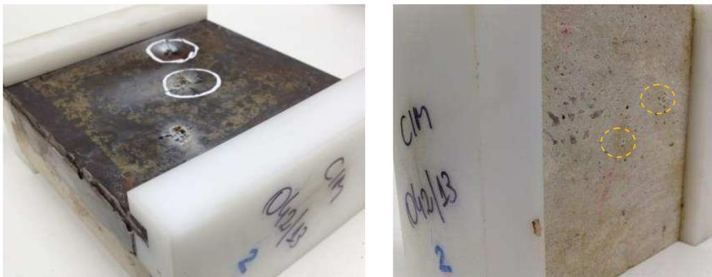
Figura 60 – Vista dos furos na placa de aço e na placa de travertino (nos círculos amarelos) da 2ª amostra de aço/cimento/carbonato travertino (CIM 042/13 - pasta pré-sal)
