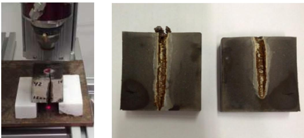
Figura 48 – Rompimento da amostra de pasta pré-sal (CIM 042/13) ao final da criação do canal a laser
