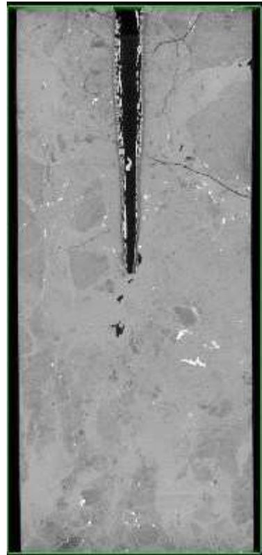
Figura 41 – Imagens da Microtomografia da amostra BB3, cilindro de Bege Bahia após a irradiação com laser
