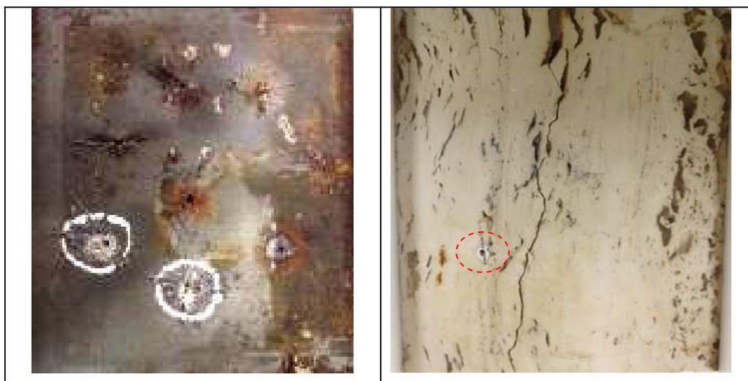
Figura 59 – Vista dos furos na placa de aço e na placa de travertino (nos círculos vermelhos) da 5ª amostra de aço/cimento/carbonato travertino (CIM 040/13 - pasta de cimento pura curada)
