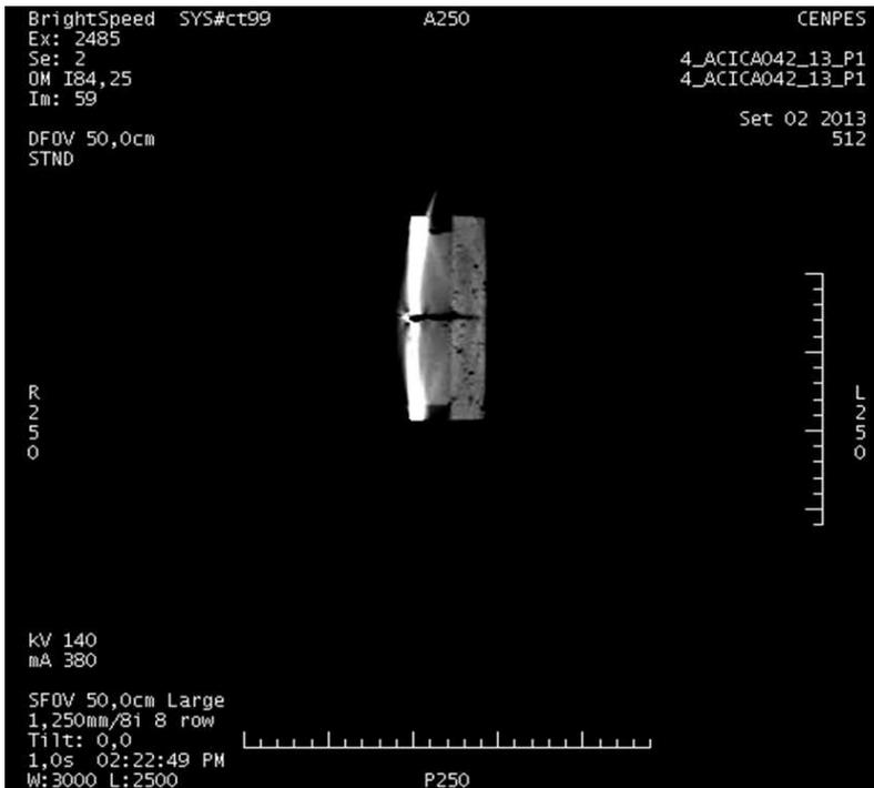
Figura 55 – Vista transversal do 1º corpo de prova de aço/cimento/carbonato travertino (pasta pré-sal) com um furo central que atravessou a amostra
