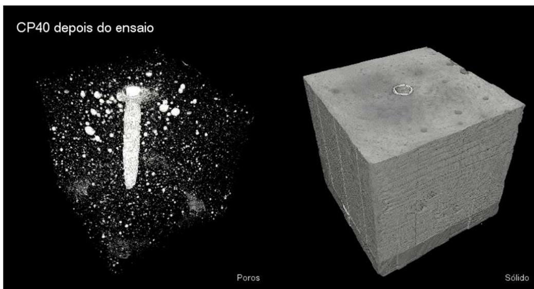
Figura 53 – Análise da porosidade da 1ª amostra de pasta de cimento pura curada (CIM 040/13) através de microtomografia após a exposição ao laser
