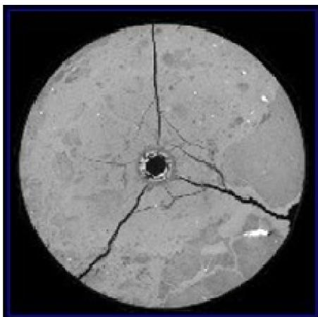
Figura 40 – Imagem da Micro-tomografia da vista superior da amostra BB3, cilindro de Bege Bahia após a irradiação com laser
