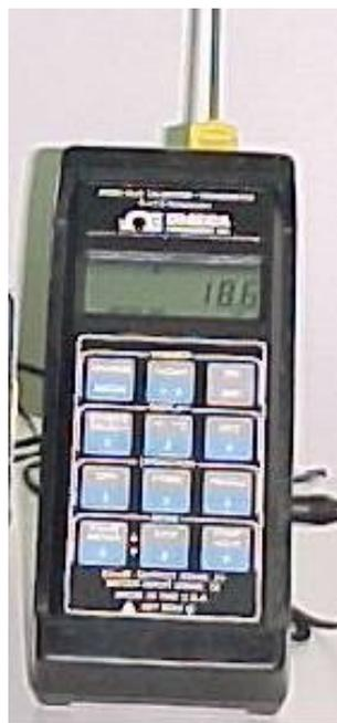
Figura 25- Termopar K, CL24 – OMEGA.
