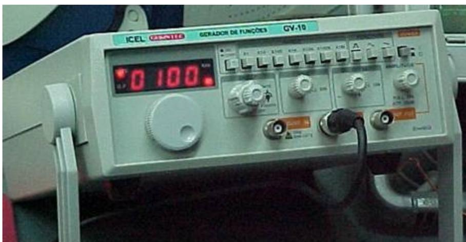
Figura 23- Gerador de funções GV-10 - ICEL-GUBINTEC.
