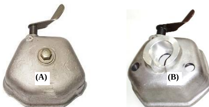
Figura 3.30: Tampas do cabeçote: original (A) e modificada (B)
