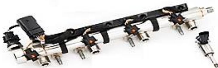
Figura 3.21: Common rail-etanol com sensor de pressão e injetor
