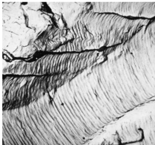
Figura 4: estrias, vistas no microscópio eletrônico, aumento não mencionado. Retirado de Callister, 2007.
