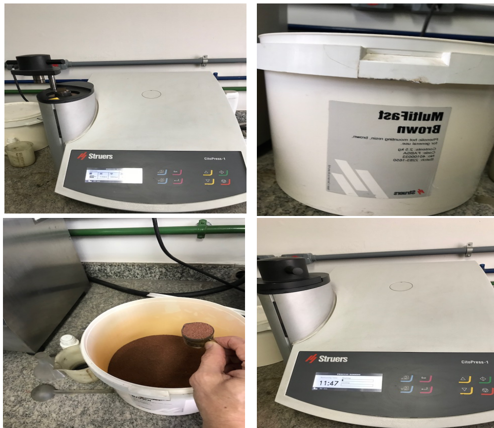
Figura 30: Imagens dos materiais e equipamento utilizados no embutimento a quente das amostras.
