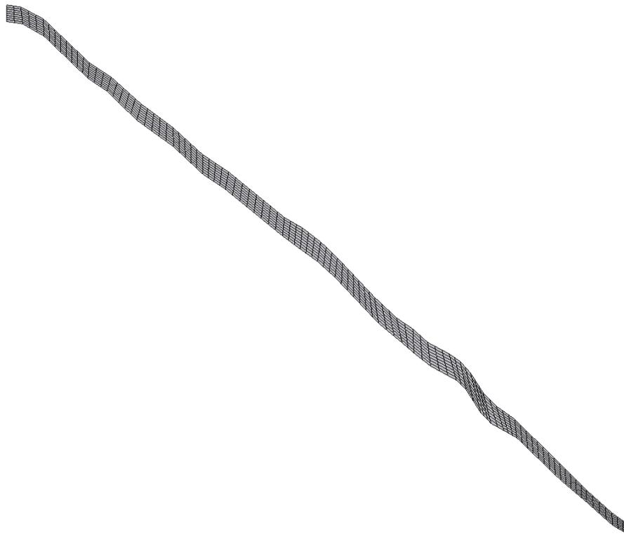
Figura 4.77 - Malha de elementos Finitos com 808 elementos.
