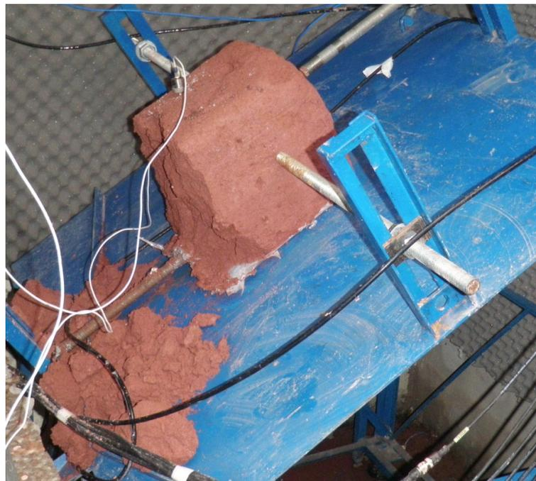
Figura 11: Bloco de solo logo após a ruptura
