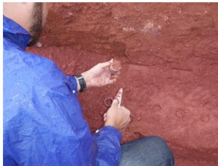
Figura 15: Moldagem em campo, dos anéis da curva característica, do solo proveniente do condomínio situado no bairro Prainha, no município de Nova Friburgo
