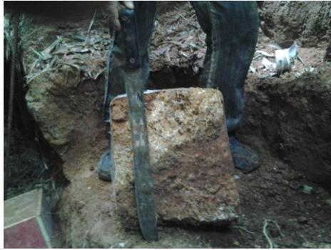
Figura 32: Retirada dos blocos do solo proveniente da PUC-Rio para execução dos ensaios
