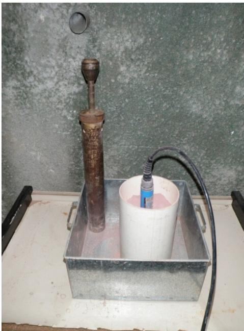
Figura 23: Detalhe dos materiais empregados para a execução da calibração dos TDR's
