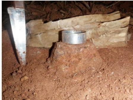
Figura 14: Moldagem em campo, dos anéis da curva característica, do solo proveniente da PUC-Rio
