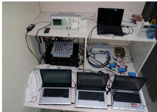
Figura 38: Centro de controle. Disposição dos equipamentos de aquisição de dados
