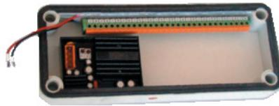
Figura 18: Condicionador de voltagem TV-Batt
