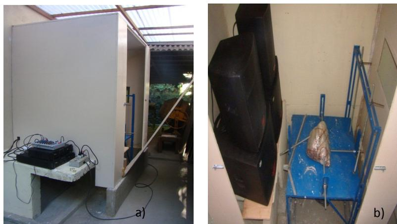
Figura 4: Construção da câmara (a) e disposição inicial da mesa e das caixas de som (b)
