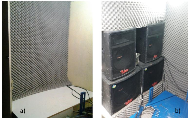
Figura 5: Aplicação do revestimento de espuma acústica (a) e disposição final da mesa e das caixas (b)
