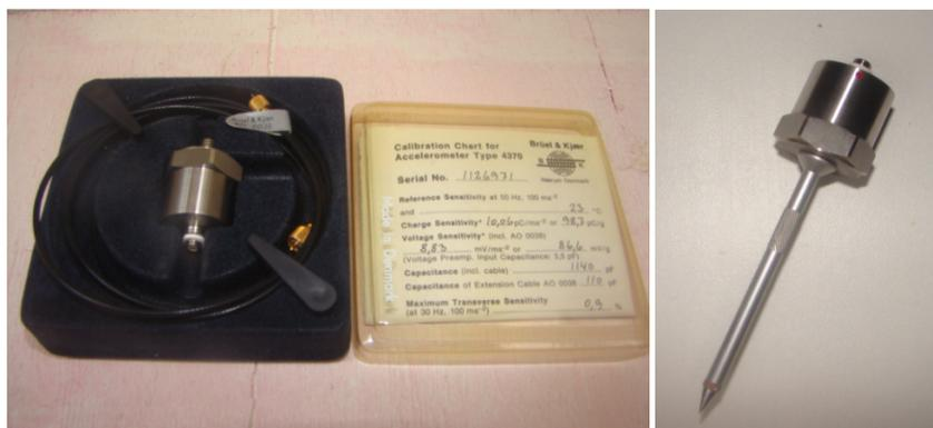
Figura 21: Imagem do acelerômetro de cisalhamento em delta (Brüel & Kjaer, 1987)
