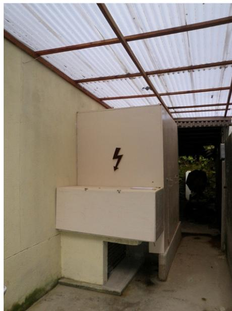
Figura 6: Visão oblíqua da câmara com o apêndice para alocar os amplificadores e instrumentos de aquisição de dados
