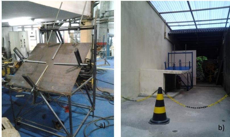
Figura 2: Etapa de construção da mesa com tampo articulado (a) e primeira disposição da mesma na área de ensaios (b)
