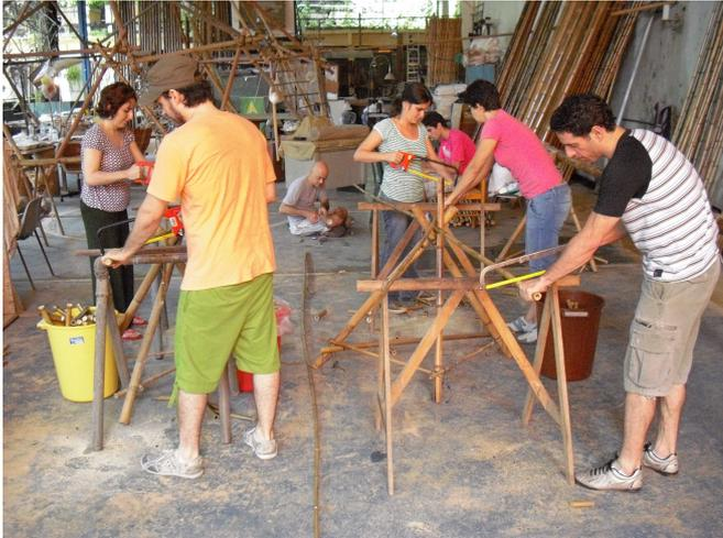
Fig.74 – cortando segmentos.
