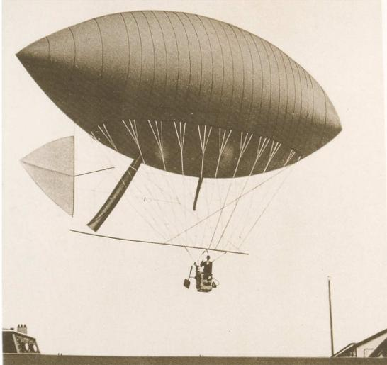
Fig.1- haste de bambu suspensa no dirigível nº3.
