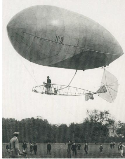
Fig.4 - viga treliçada autotencionada no dirigível nº9.
