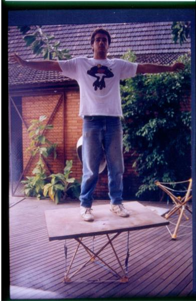
Fig. 20 – Prisma Autotencionado com bambus e cabos.
