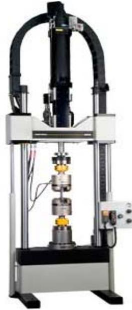
Figura 1.2 Máquina Instron 8802TT para ensaios de fadiga multiaxial [17]
