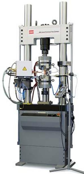
Figura 1.3 Máquina MTS tração torção modelo 370.02 [19]
