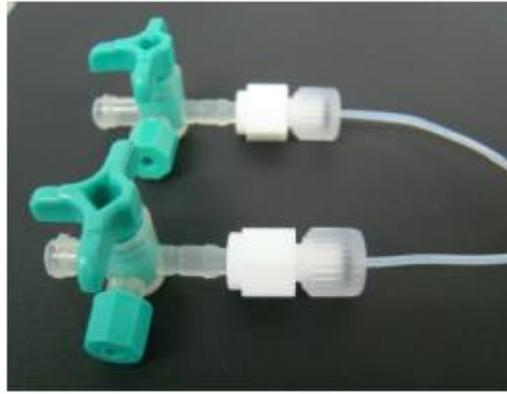
**Figura 3. 28** Conexões entre a seringa e o micromodelo.
