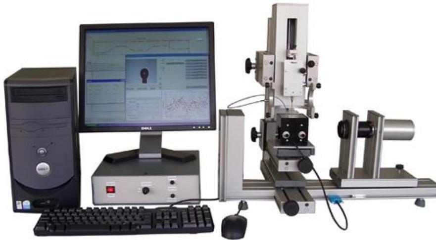
**Figura 3. 10** Tensiômetro TRACKER, baseado no método da gota pendente.
