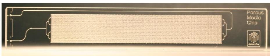
**Figura 3. 20** Meio poroso utilizado na visualização do processo de deslocamento de óleo por injeção de emulsões.
