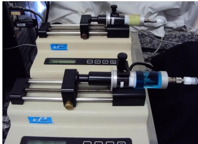
**Figura 3. 35** Montagem das seringas nas bombas COLE PARMER.
