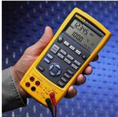
Figura 25: Calibrador de Temperatura modelo 724 de fabricação Fluke.
