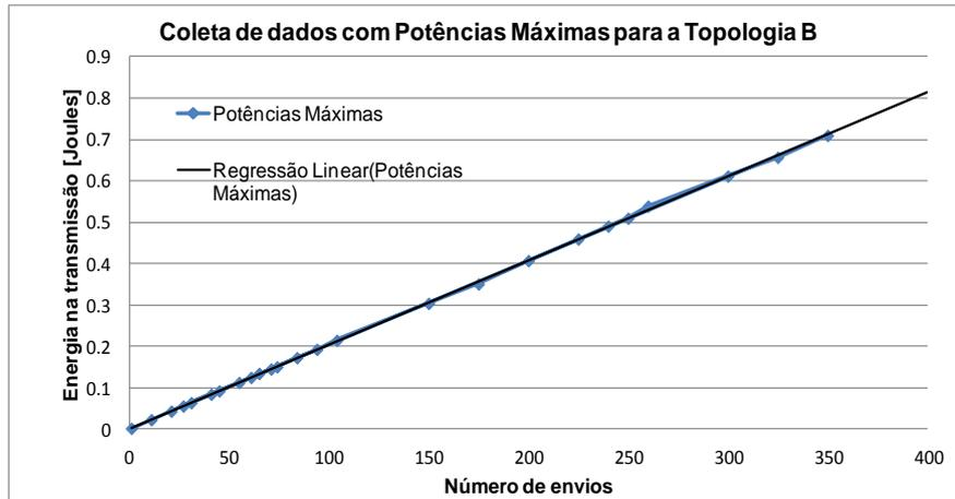
**Figura 4.11: Coleta de dados com potências máximas para a Topologia B**
