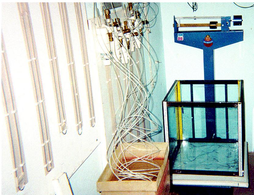
**FIGURA 5.29:** Vista do Esquema Montado para os Ensaios de Ressecamento: Detalhe dos Tensiômetros.
