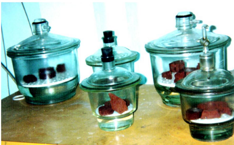
**FIGURA 5.28:** Vista dos Dessecadores Usados para Medição de Sucção Total.
