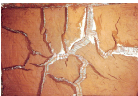
FIGURA 8.50: Seqüência de Secagem da Lama Vermelha OP Neutralizada em Lisímetros Menores.
