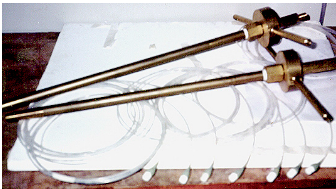
FIGURA 8.5: Amostradores e Tensiômetros Usados nos Ensaios de Secagem.
