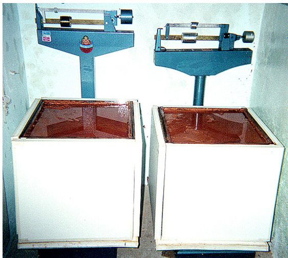
FIGURA 8.2: Lisímetros Com Lama Para Ensaio de Secagem Controlada.
