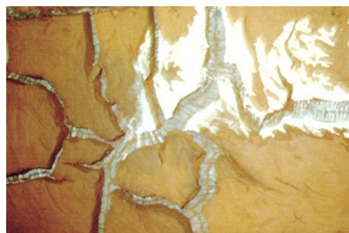
FIGURA 8.50: Seqüência de Secagem da Lama Vermelha OP Neutralizada em Lisímetros Menores.
