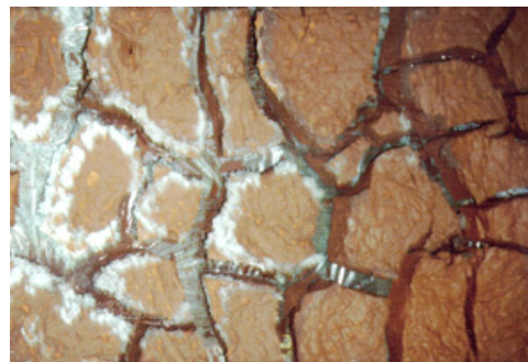
FIGURA 8.51: Seqüência de Secagem da Lama Vermelha OP Não Neutralizada em Lisímetros Menores.
