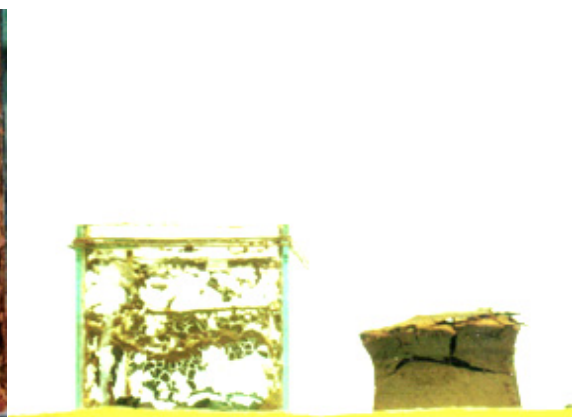
FIGURA 8.54: Trinca Formada Horizontalmente na LV04.
