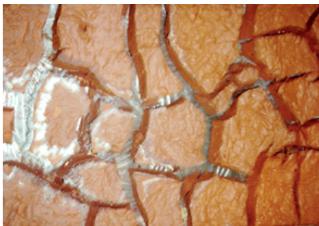
FIGURA 8.51: Seqüência de Secagem da Lama Vermelha OP Não Neutralizada em Lisímetros Menores.
