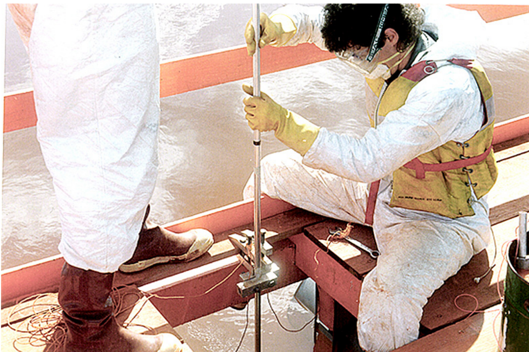
FIGURA 7.16: Descida da Sonda em Resíduos Muito Moles
