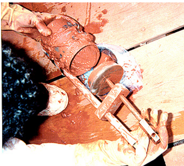
FIGURA 7.19: Uso do Amostrador Para Lamas de Baixa Densidade
