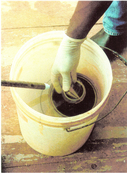
FIGURA 7.14: Seqüência de Montagem Da Ponta Cônica da Sonda Piezométrica
