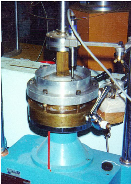
**FIGURA 6.29:** Ensaio em Andamento no Edômetro Tipo CRS
