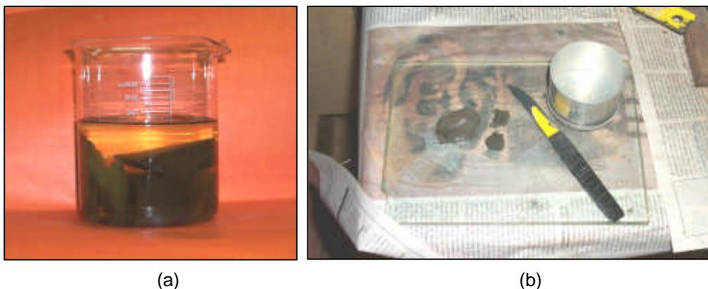
Figura 82 - (a) Amostras de folhelho no interior de um becker e (b) amostra do folhelho sendo moldada em câmara úmida.
