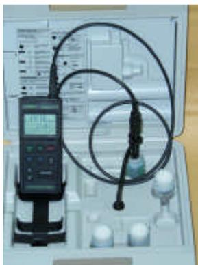
Figura 80 - Execução do ensaio de calibração da sonda de condutividade elétrica.
