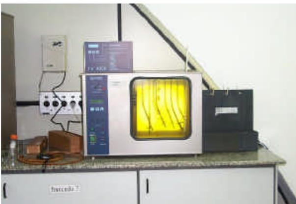
Figura 59 - Banho utilizado para a realização dos ensaios de viscosidade.
