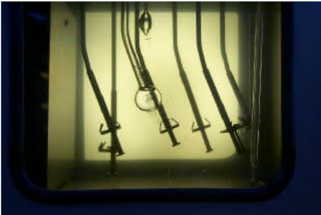
Figura 58 - Viscosímetro 1082 no interior do banho térmico com glicerina a  $50^{\circ}$ C.
