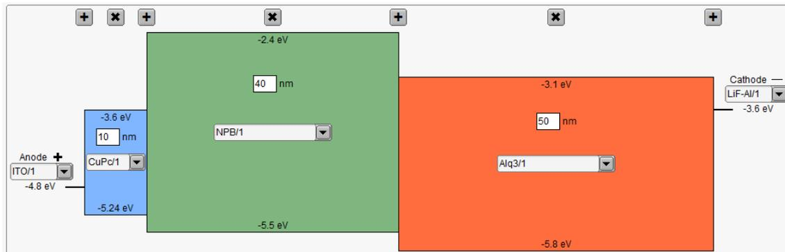
Figura 3.9: Representação do OLED tricamada no SimOLED.
