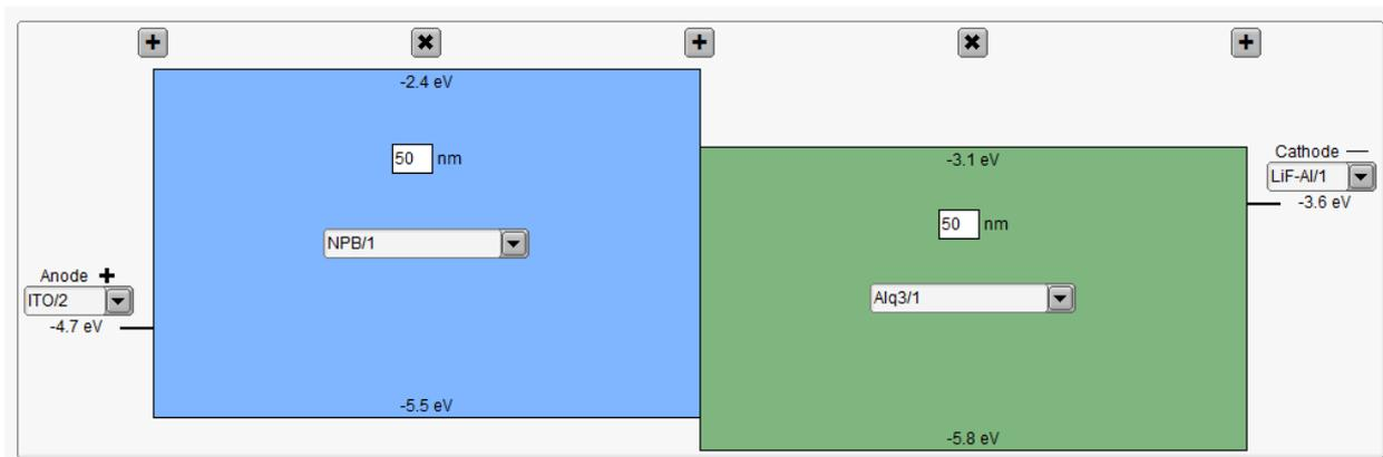
Figura 3.7: Representação do OLED bicamada no SimOLED.
