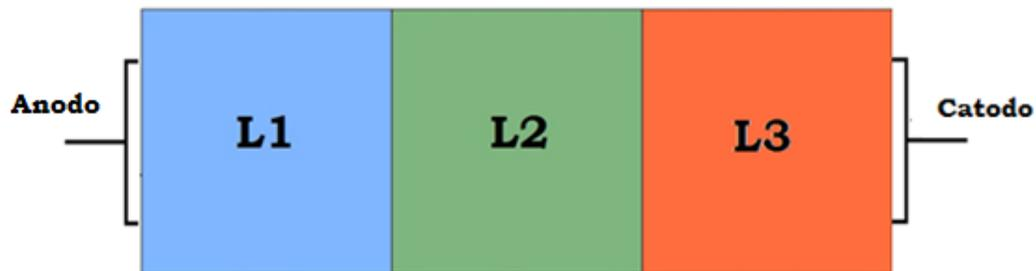
Figura. 2.7: Estrutura de um OLED tricamada.
