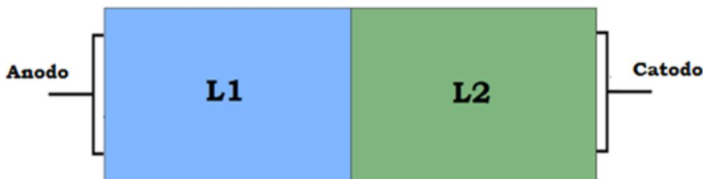
Figura 2.6: Estrutura de um OLED bicamada.
