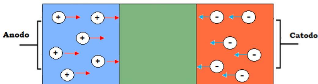
Figura 2.11: Transporte de buracos e elétrons.
