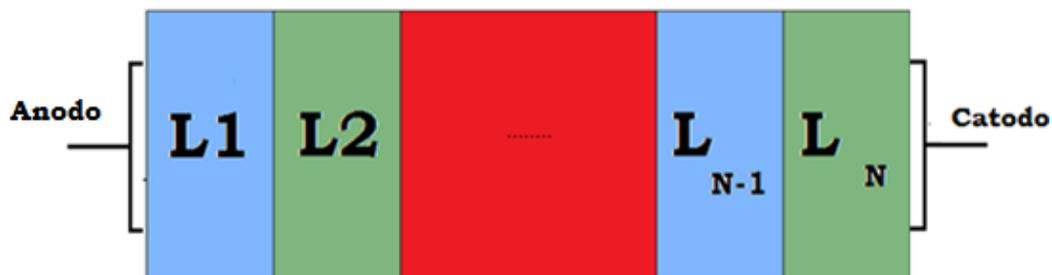
Figura 2.8: Estrutura geral de um ML-OLED.
