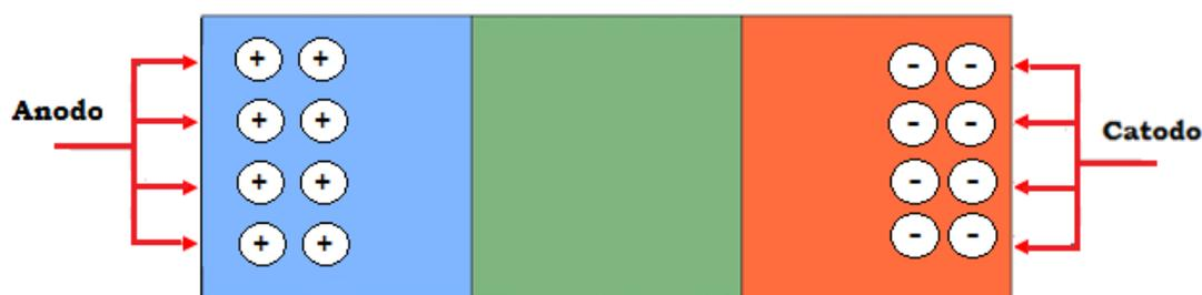
Figura 2.10: Injeção de buracos e elétrons.
