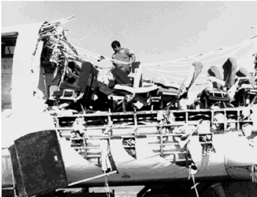
Figura 1.4 – Acidente de um avião causado pela propagação uma trinca por fadiga.
