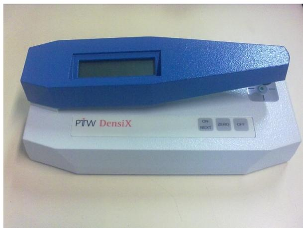
FIGURA 19 – Densitômetro Óptico PTW-DensiX tipo T52001 [53].
