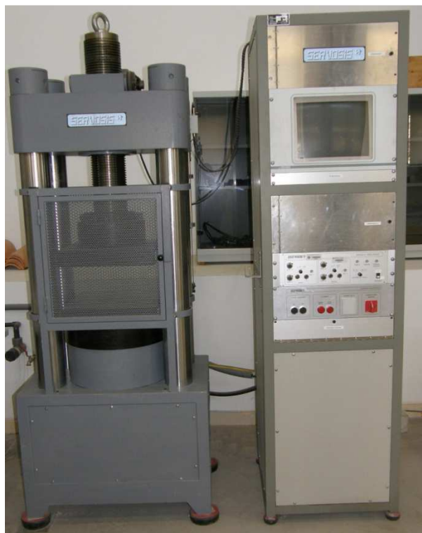
Figura 4.3 – Máquina servo-hidráulica de ensaios de compressão.
