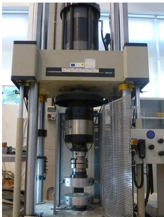
Figura 4.8 – Máquina de ensaios utilizada para os ensaios de fadiga.
