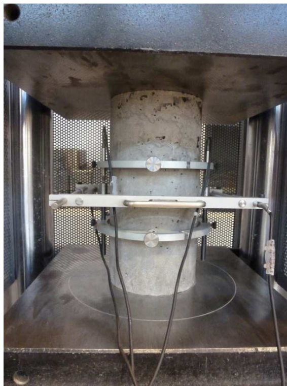
Figura 4.4 – Extensometria axial e radial em um corpo de prova cilíndrico: ensaio de módulo de elasticidade e coeficiente de Poisson.
