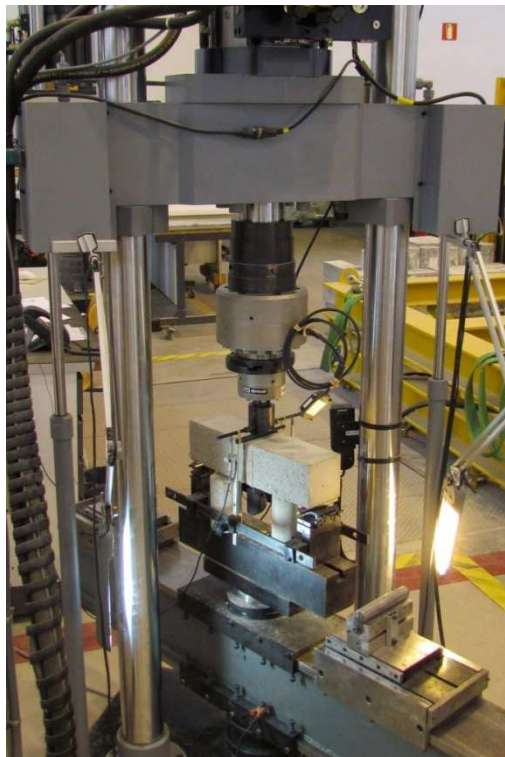
Figura 4.5 – Máquina híbrida adaptada para ensaios de flexão em três pontos.
