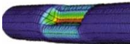
Figura 2.25 - Simulação de revestimento colapsado devido aos esforços localizados pelo sal (Zhang, Standifird e Lenamond, 2008).
