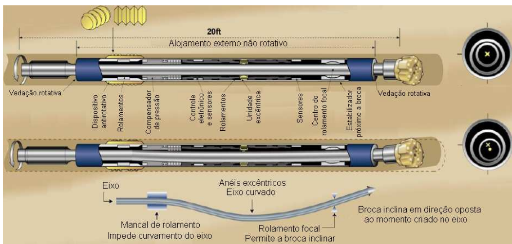
Figura 2.35 - RSS em operação de desvio point-the-bit , adaptado de Savino (2009) apud Halliburton (2007).
