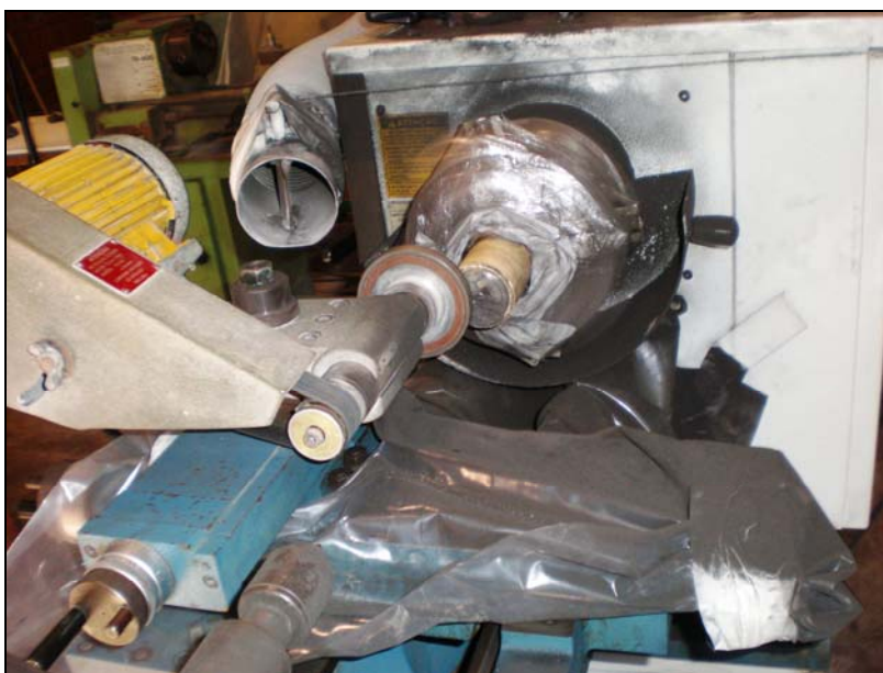
Figura 32 – Faceamento do topo e base do corpo de prova
