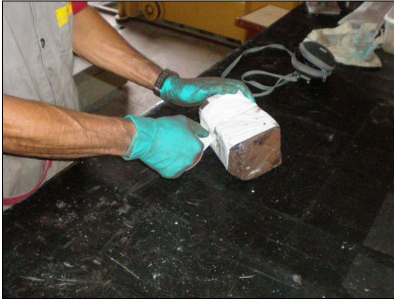
Figura 31 - Fita adesiva para evitar a propagação de fissuras na amostra
