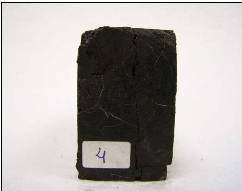
Figura 29 – Amostra utilizada para análise de permeabilidade nas seis arestas.
