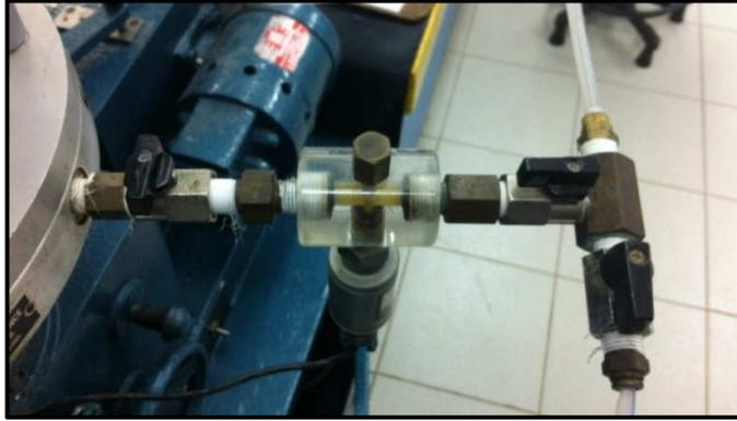
Figura 3.17 – Transdutor de pressão durante execução do ensaio
