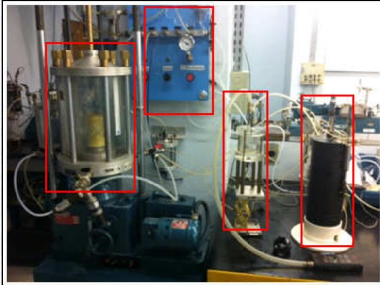
Figura 3.13 – Componentes do sistema triaxial utilizado na pesquisa
