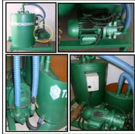
Figura 3.9 – Bomba de vácuo
