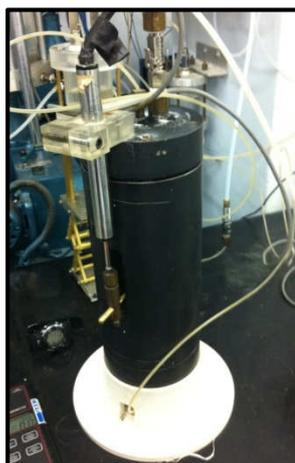
Figura 3.16 – Medidor de Variação Volumétrica
