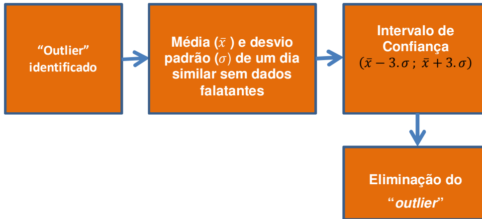
Figura 18 – Diagrama de blocos rotina tratamento de “outlier” Fonte o autor
