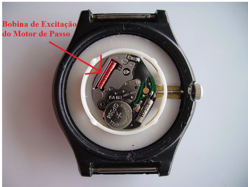
Figura 69 – Mecanismo interno de um relógio de quartzo típico, destacando-se sua bobina de excitação.
