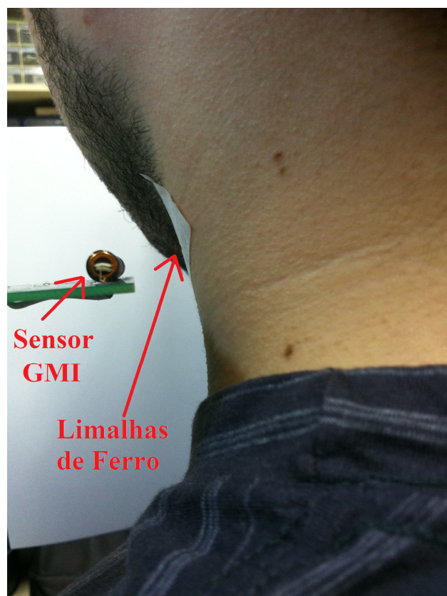
Figura 84 – Arranjo experimental implementado para a medição direta da onda de pulso arterial carotídeo, com o magnetômetro GMI aqui desenvolvido.
