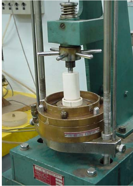
Figura 4.1 – Ensaio de compactação na prensa edométrica.
