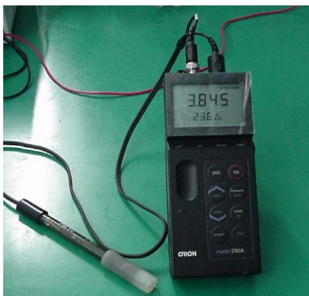
Figura 3.14 - Potenciômetro digital Orion, modelo – 290A.
