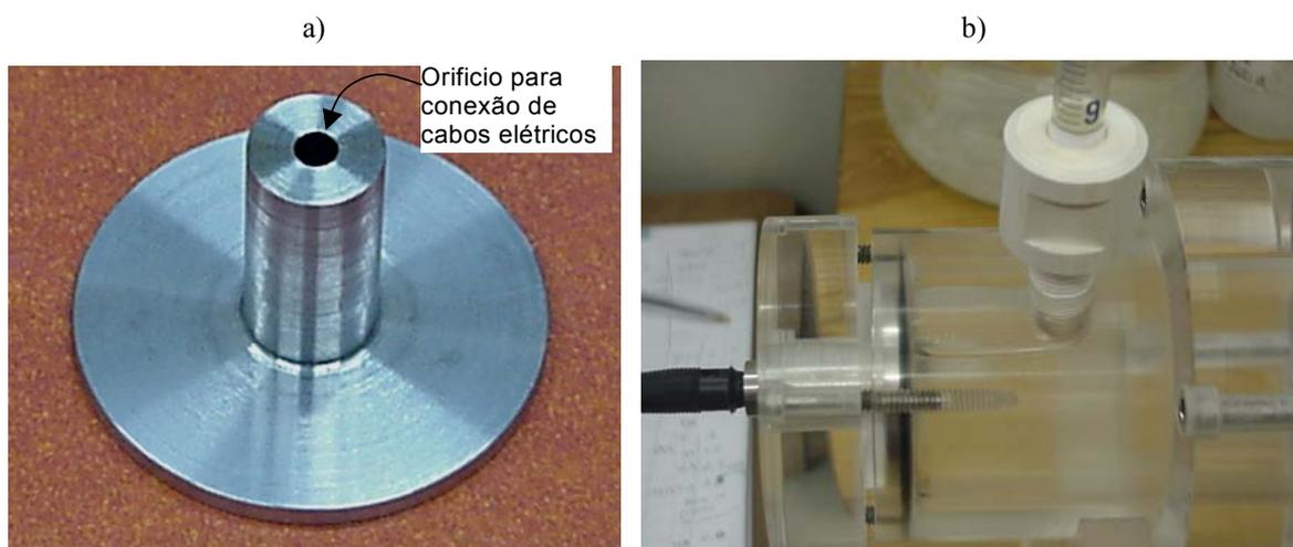
Figura 3.11 - Eletrodo de aço inox 316. a) eletrodo; b) detalhe do fixador de eletrodo engatado no reservatório e o eletrodo.
