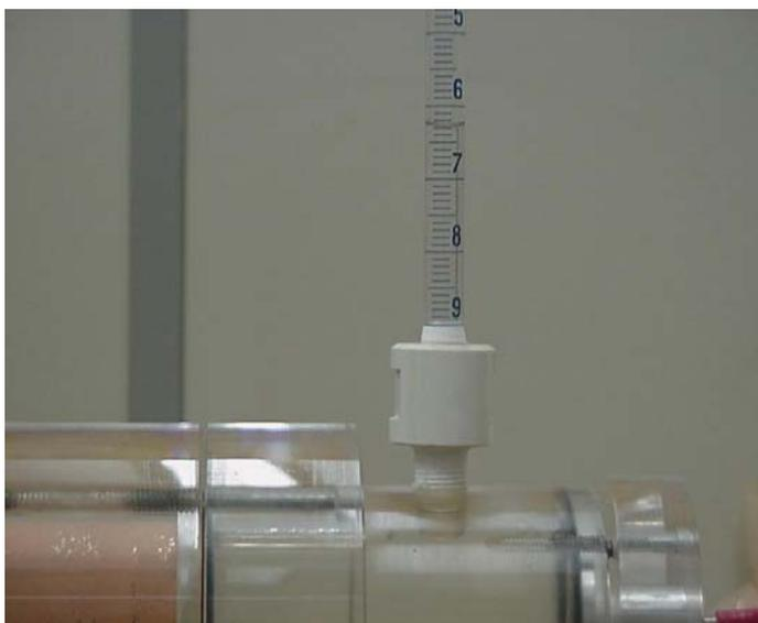
Figura 3.13 - Detalhe do encaixe da pipeta graduada na luva de PVC encaixada no reservatório da célula de eletrocinese.
