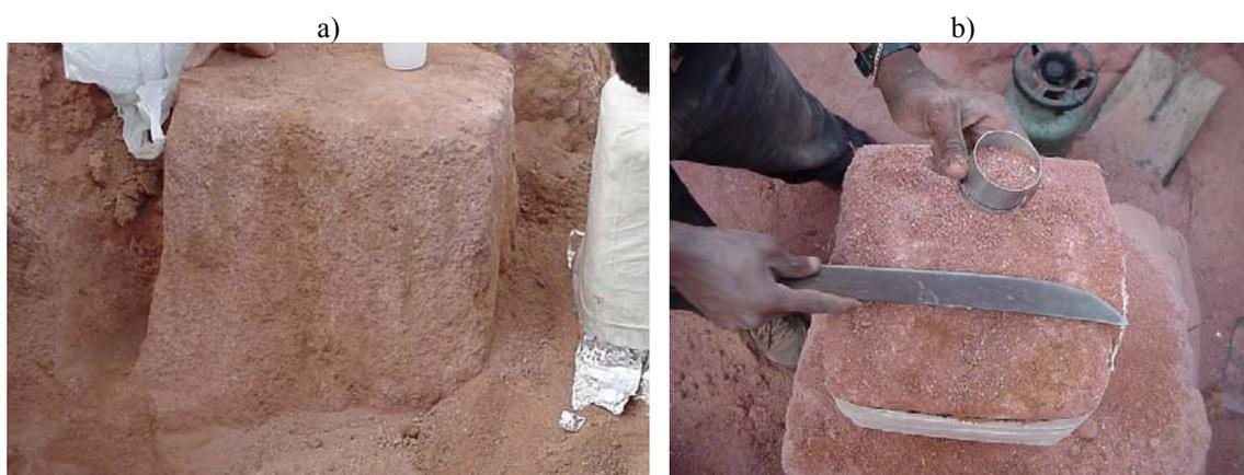
Figura 3.2 - Coleta e amostragem em perfil de intemperismo de solo residual jovem localizado em talude de corte na Rodovia Washington Luís, BR 040 - km 111, Rua Emília Garcia s/n.
