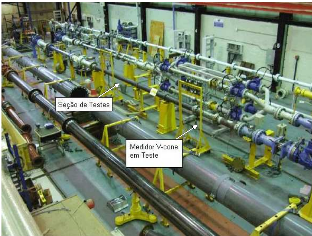
Figura 13 – Circuito de testes do laboratório NEL
