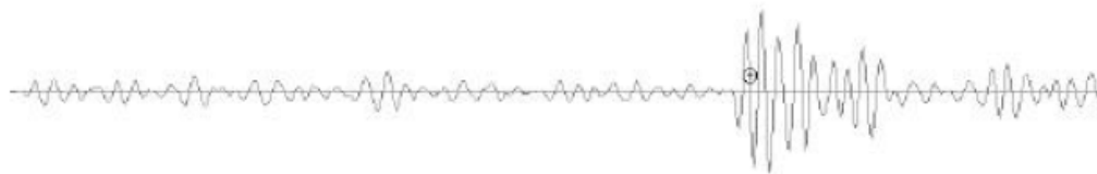
Figura 14 – Sinal típico de um transdutor ultrassônico [17].
