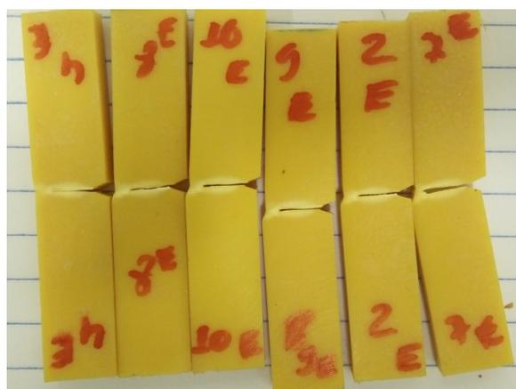
**Figura 5.37** Corpos de prova que não fraturaram após o ensaio.
