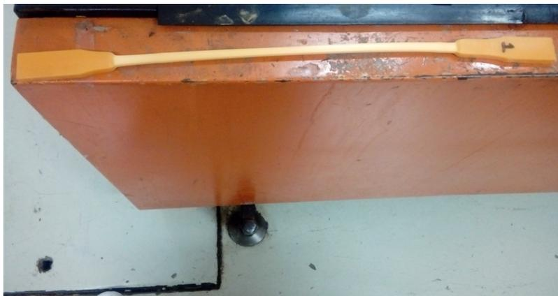
**Figura5.3 Alongamento final do PEAD sem que tenha havido ruptura.**
