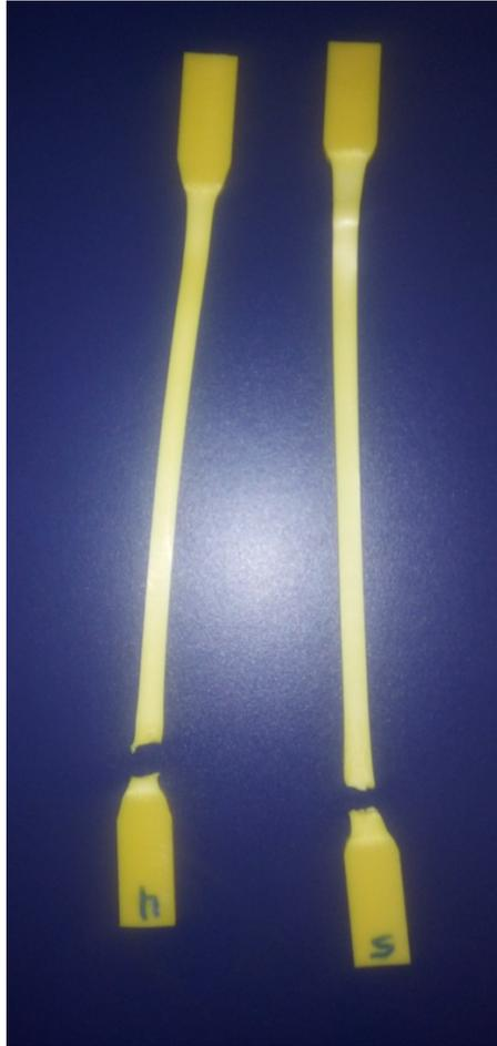
**Figura 5.9** Corpos de Prova fraturados da Poliamida 12 original.
