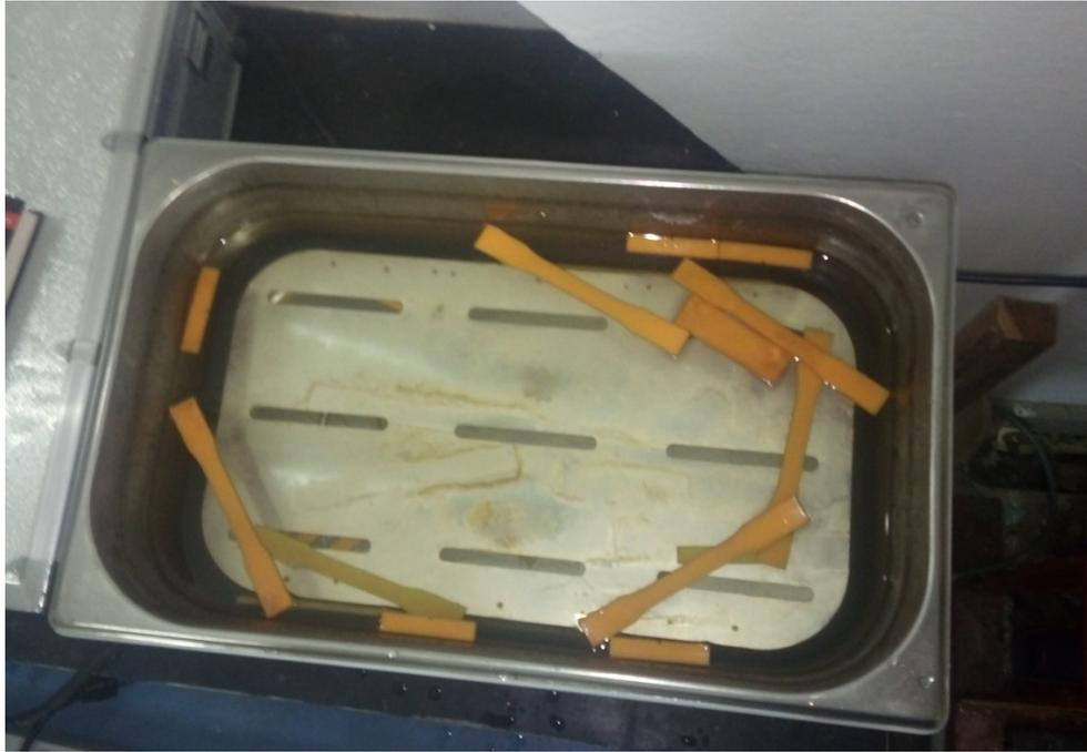
Figura 4.7 Corpos de prova submersos dentro de um banho-maria.
