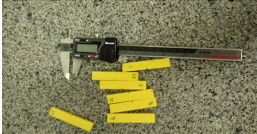
Figura 4.14 Corpos de prova de impacto.
