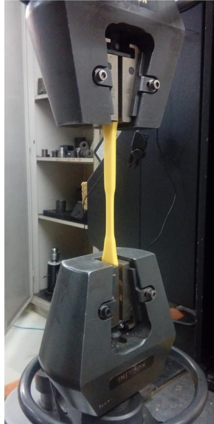
Figura 4.9 Ensaio de tração na Poliamida 12.
